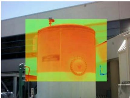
Incrustation d'image Ti400 en mode AutoBlend : niveau de réservoirs industriels de stockage
